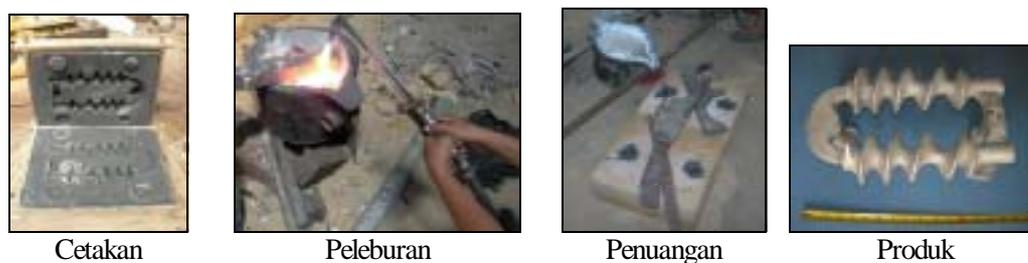
**Gambar 4. Proses pengecoran**
